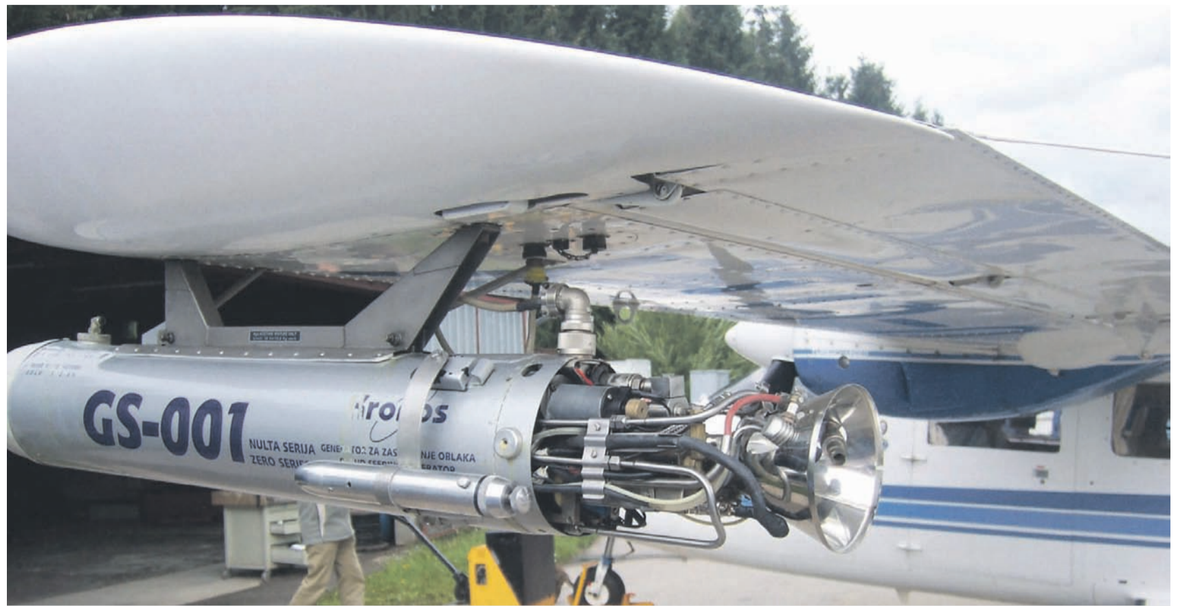
20-Liter Silberjodid-Generator an den Tragflächen einer Partenavia P68 C-TC.
