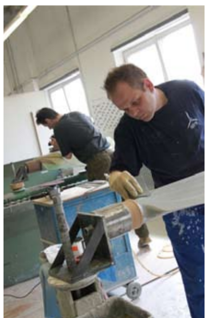
Propellerblätter werden gespachtelt vor dem Lackieren.
