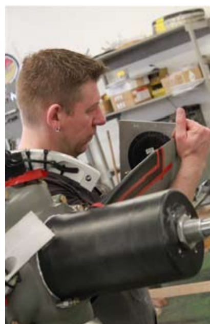
Der eingestellte Blattwinkel wird kontrolliert.
