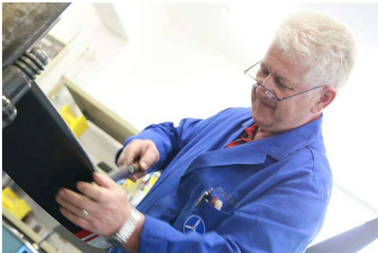
Mit Mut, Feingefühl und viel Erfahrung werden sogenannte „Macken“ aus einem Propellerblatt gefeilt.
